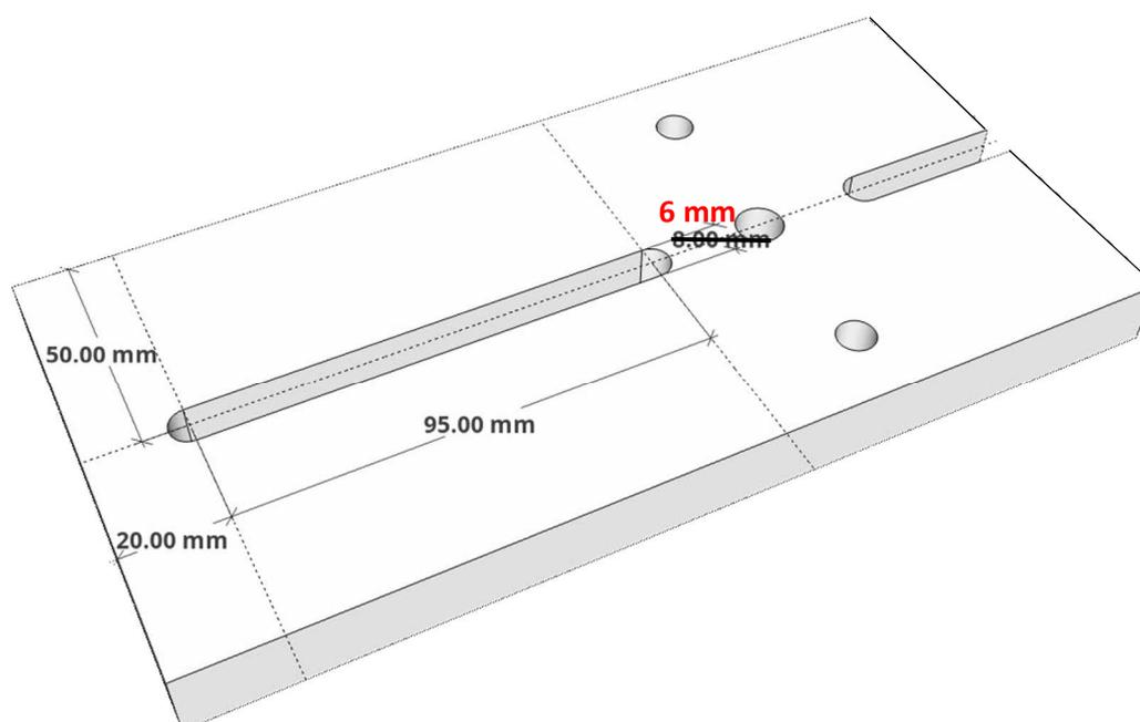
Nun können wir die beiden Dübel in die 8 mm Löcher und die Hülse einleimen und unser Werkstück sollte so aussehen.
