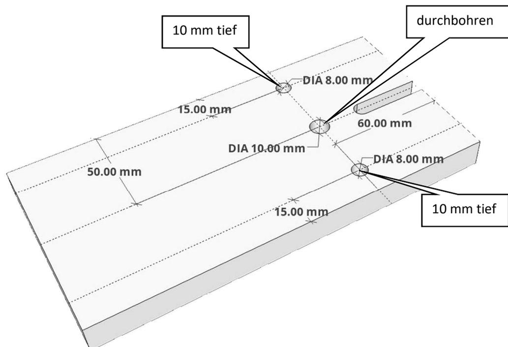
Als nächstes müssen wir entsprechend der Maßangaben einen Schlitz in das Werkstück einarbeiten. Dieser dient später dem Verstellen des unteren Schiebers.
