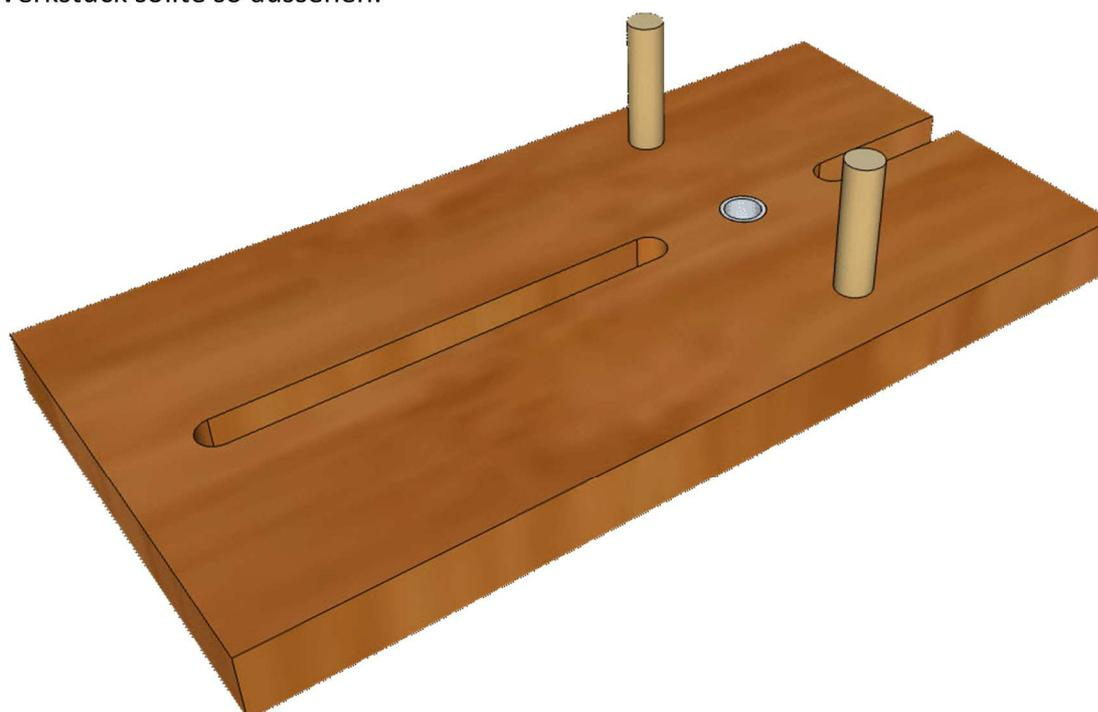
Kommen wir nun zum Unterteil. Zunächst wird die Mitte ermittelt und die eine Seite, die später nach unten zeigt, wird mit dem 18 mm Forstnerbohrer 2 mm tief eingebohrt. Diese Bohrung nimmt später den Rand von der Einschlagmutter auf. Anschließend kann auf dem Zentrierpunkt des Forstnerbohrers mit einem 7,5mm Bohrer das Werkstück durchgebohrt werden. Bitte auch hier wieder mit der Ständerbohrmaschine um die Rechtwinkeligkeit zu gewährleisten.
