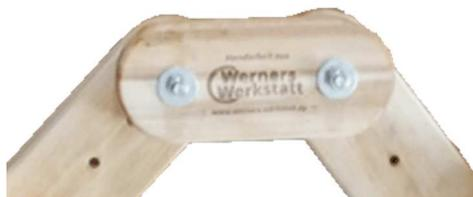
Als nächstes werden die Winkel mit den M 6 x 60 Schloßschrauben, Unterlegscheiben und Flügelmuttern auf die langen Schenkel aufgeschraubt. Hierbei ist darauf zu achten, dass die Winkel immer auf der gleichen Höhe verbaut werden. Die Flügelmutter werden nur leicht gegengezogen, sodass sich die Winkel noch bewegen können.
