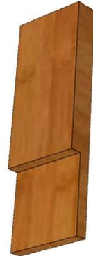
Das Material ist 15 mm Multiplex. Der senkrechte Anschlag ist 20 mm Material.
