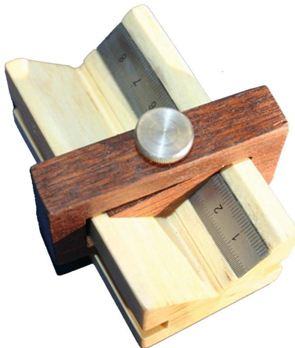
In diesem Bauplan geht es um eine Einstellhilfe um Bohrer, Fräser oder die Kreissäge auf ein festes Tiefenmaß einzustellen.
