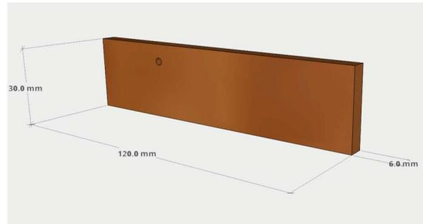
Nun folgt der Zuschnitt des Mittelkerns. Dieser kann zunächst in einem Block mit den Maßen Länge 120 mm x Höhe 30 mm x Breite 26 mm hergestellt werden. Hierfür ist die Esche gedacht.
