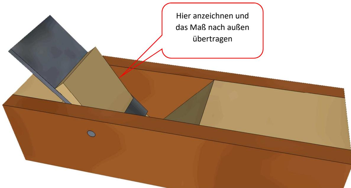
Das Hobelmesser und den Keil in das Spanloch einsetzen und etwas oberhalb der Mitte einen Punkt anzeichnen an dem der Widerlagerstift durchgeführt werden soll. Nun den Punkt mittels Maßstab auf die äußeren Seiten übertragen. Jetzt kann mit einem 3 mm Bohrer durchgebohrt werden. Um einen Spanausriss im Spanloch zu vermeiden empfehle ich ein passendes Opferholz zu benutzen.
