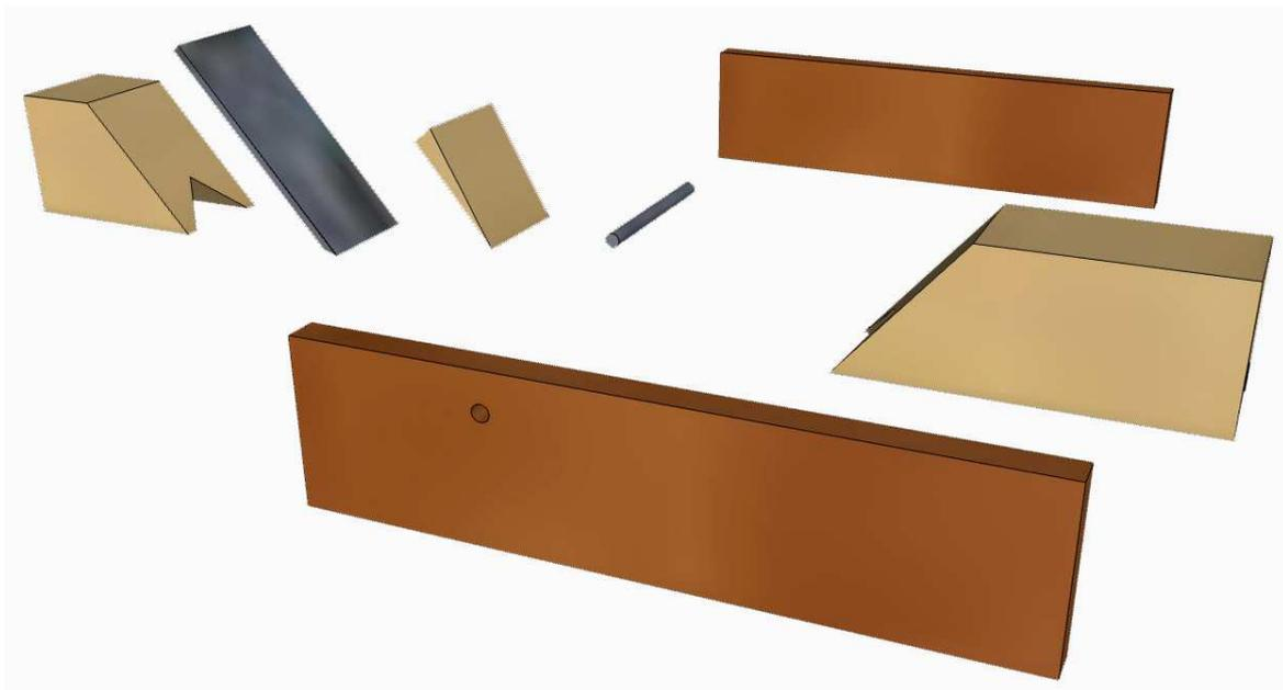
In diesem Fall besteht der Hobel aus zwei verschiedenen Holzarten. Die Wangen sind aus Mahagoni und der Mittelkern ist aus Esche. Es sollte auf jeden Fall Hartholz verwendet werden.
