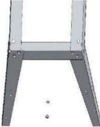
Abb. 8: Standfüße der Maschine montieren
