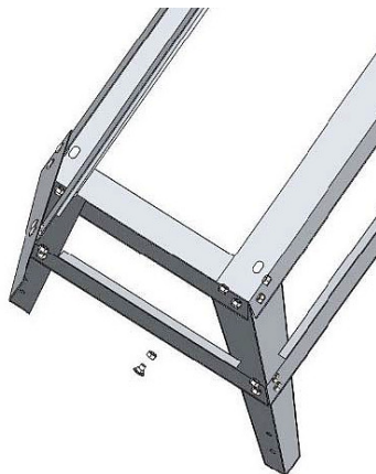
Abb. 9: Querstreben der Maschine montieren
