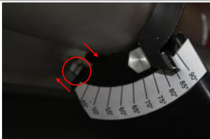
Parallelanschlag auf vertikal 90° justieren:
