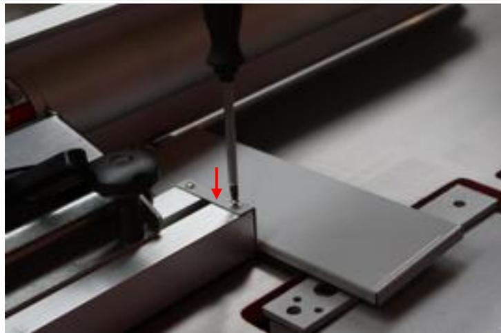
Hobelwellenabdeckung mit den zwei Kreuzschrauben montieren.
