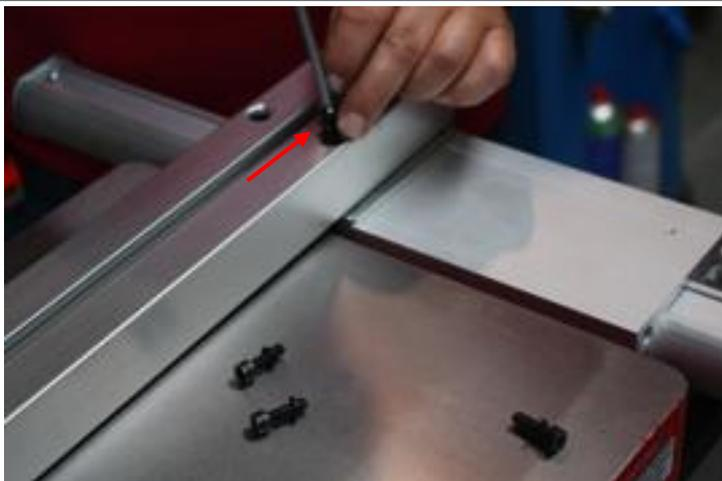
Parallelanschlag mit den 4 Schrauben + Beilagscheiben auf die Führung montieren.
