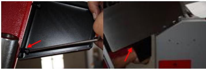
Anschlagsupport mit einem Inbuschlüssel an den dafür vorgesehenen Bohrungen an der Rückseite des Eingangstisches befestigen.
