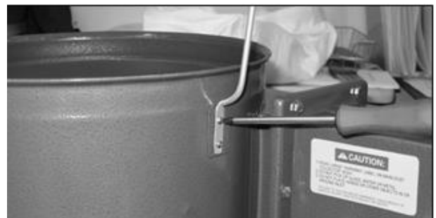
Bild 6 Haltestange oben anschrauben / Install upper bag support / Tornillo barra de retención por encima de
