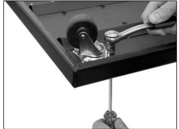
Bild 1 Anbau der Lenkrollen / Mounting of the swivel casters / El cultivo de ruedas
